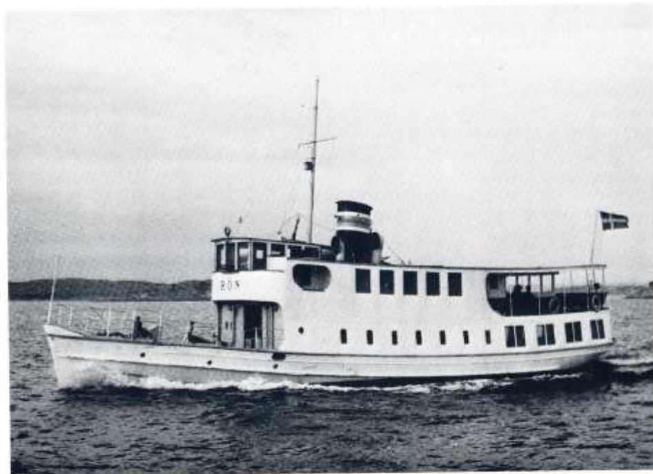
ÄRLAN efter ombyggnaden till motorfartyget RÖN. Efter den stora ombyggnaden 1948 gjordes ytterligare några förändringar av exteriören. 1951 fick hon ny styrhytt och några år senare byggdes den raka stäven om till "soft nose". Foto Dag Almén 14 juli 1959.
